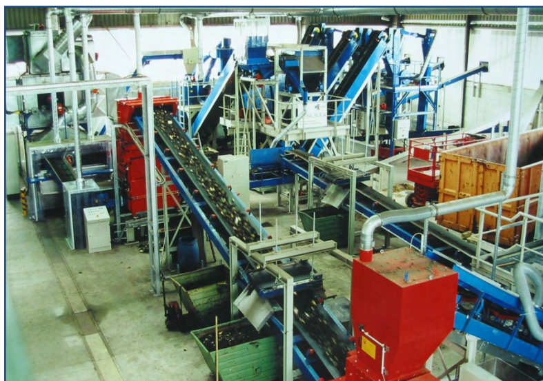
Figure 18 : Exemple d'une installation de séparation mécanique-physique
