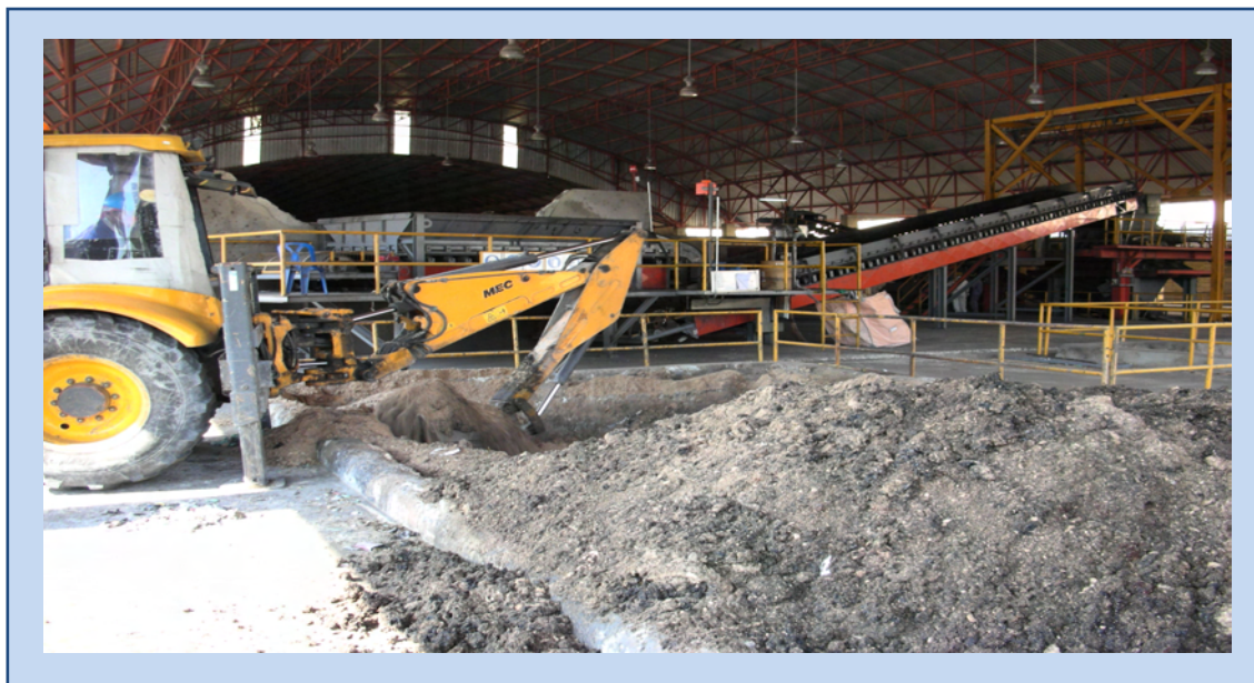
Figure 6: Fabrication de combustible secondaire solide par mélange de déchets dangereux avec des sciures, suivi d'un tamisage [Photo : WhiteLabel]
